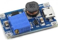
**Step-down Modul 2..24V till 5...28V, 2A, USB A**
